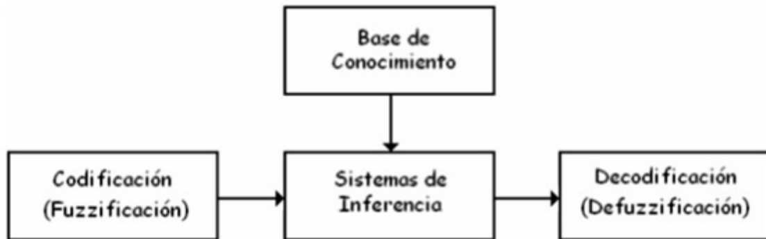
Figura 3.1: Estructura general de un controlador difuso.
