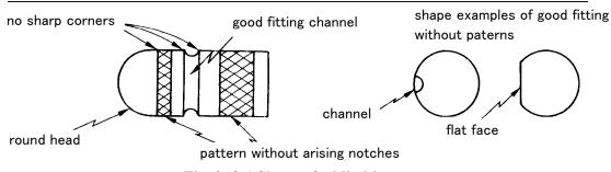
Fig. 2 · 3-1 Shape of a blind insert
