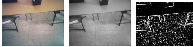
**Figura 4** A la izquierda se muestra la Imagen original como se captura con la cámara. En el centro se muestra la imagen transformada a escala de grises. La imagen de la derecha corresponde al fondo de la escena, resultado de aplicar el filtro de umbral adaptativo.
