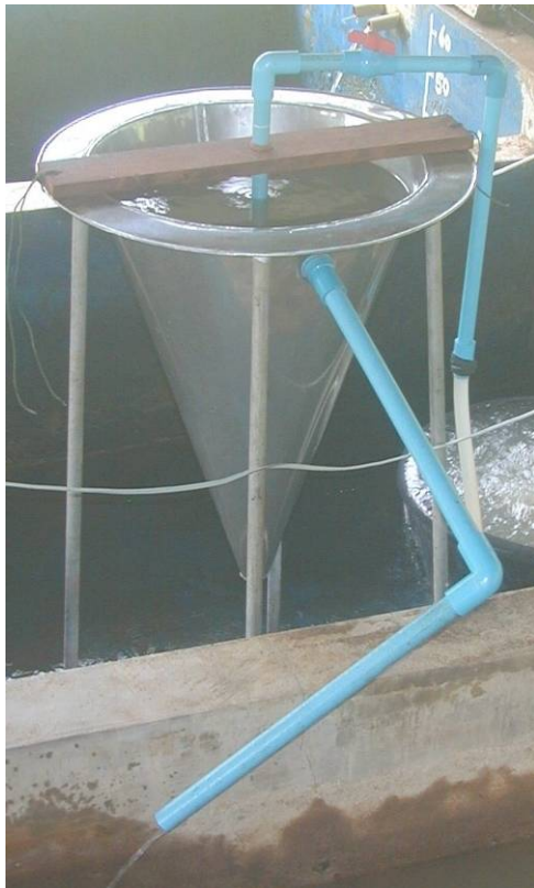
Photo 2 : Incubateur de type Mc Donald confectionné dans une plaque de métal inoxydable et utilisé pour l'incubation des oeufs de Clarias gariepinus maintenus en suspension.
