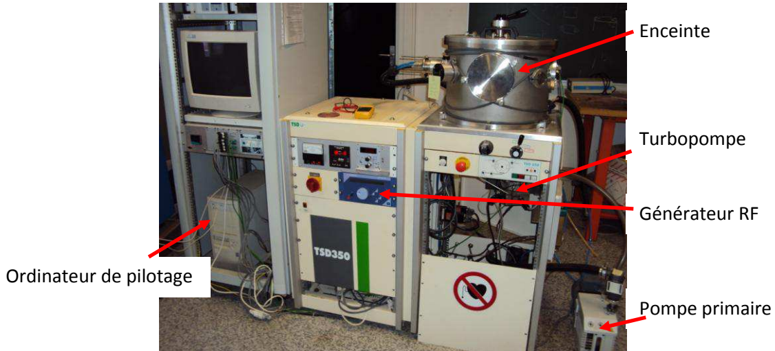
Fig. n°III.11 : Dispositif expérimental de pulvérisation cathodique RF
