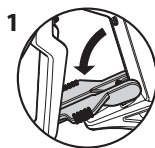
Trekker vergrendeld (spuiten met pistoolniet mogelijk)
