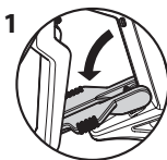
Gatilho bloqueado (a pistola não pulveriza)
