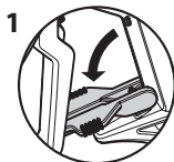
Pistola travada (a pistola não pulverizará)
