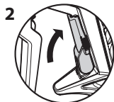
Gatillo desbloqueado (la pistola sí pulveriza)
