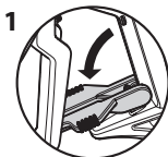
Gatillo bloqueado (la pistola no pulveriza)
