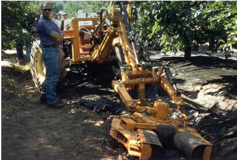
Figura 2: Maquina vibradora
