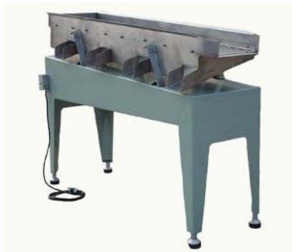
Figura 5.: Clasificadora mecánica
