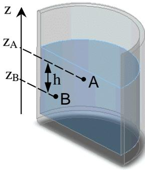
Considérons 2 points A et B dans un fluide à des altitudes différentes  $z_A$  et  $z_B$ . Les pressions  $p_A$  et  $p_B$  respectivement au point A et B sont alors liées par la relation suivante :
