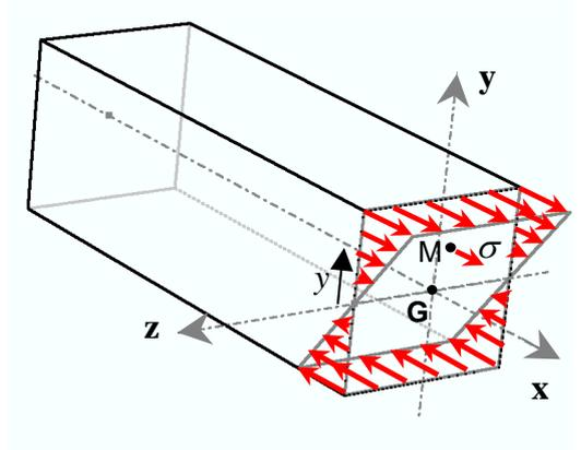
La contrainte normale engendrée est nulle le long de l'axe (Gz) (fibre neutre) et est de plus en plus élevée lorsqu'on s'en éloigne.
