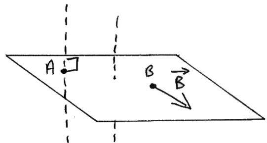
→ **sens** : on applique la **règle du « tire-bouchon »** en considérant que  $\vec{B}_{1 \rightarrow 2}$  fait tourner le tire-bouchon autour de A. :
