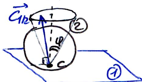
$\vec{C}_{1 \rightarrow 2}$  est comprise dans un cône de demi-angle au sommet  $\varphi$  par rapport à la normale au contact.
