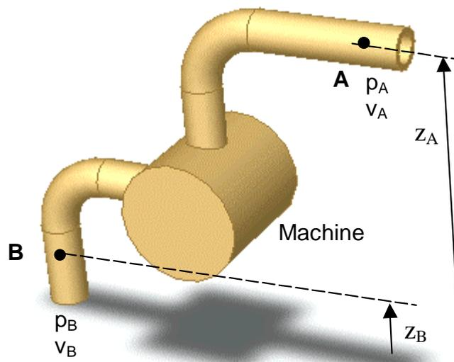
L'énergie mécanique totale d'un fluide devant rester constante, la variation totale d'énergie par unité de masse entre 2 points d'un circuit hydraulique doit rester nulle (en J/kg) :
