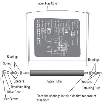
Figure 40. Platen Roller
