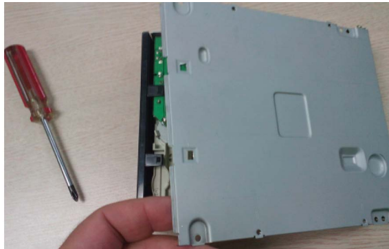
Ilustración 2.54: Desarmar lectora CD/DVD paso 2
