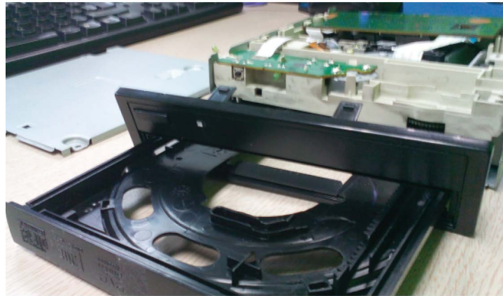
Ilustración 2.56: Desarmar lectora CD/DVD paso 4
