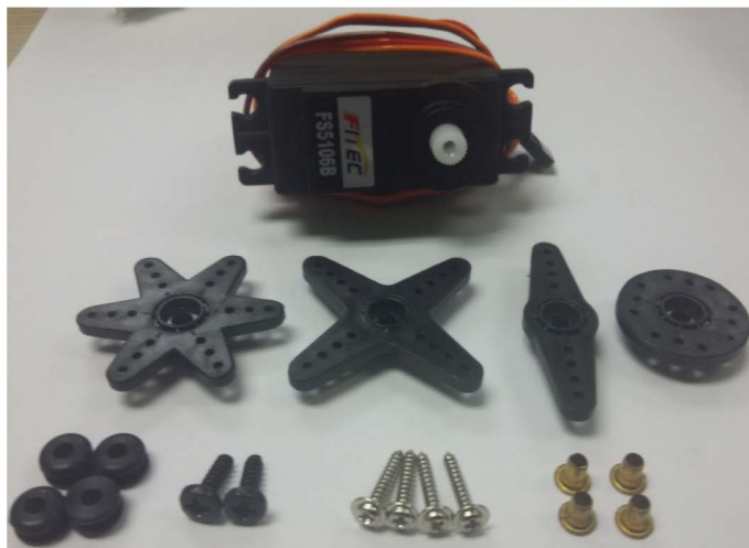
Ilustración 2.42: Servo Motor FS5106B con sus accesorios de piñonería.
