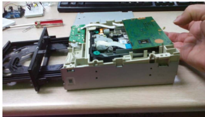
Ilustración 2.57: Desarmar lectora CD/DVD paso 5
