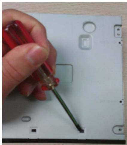
Ilustración 2.55: Desarmar lectora CD/DVD paso 3
