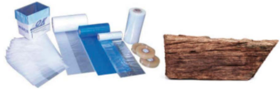
Ilustración 1.10: Materiales no conductores
