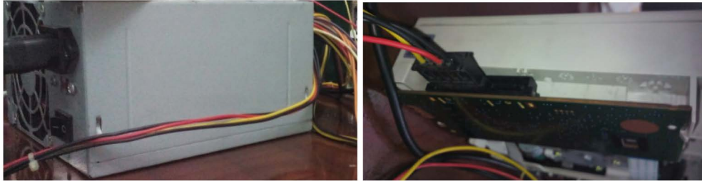
Ilustración 2.62: Fuente conectada a lectora de CD/DVD
