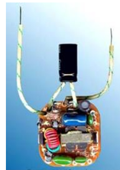
Elementos que componen el balastro electrónico. Fig. 8-11
