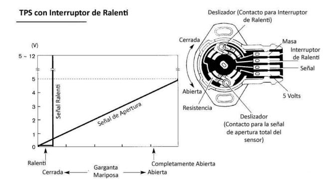
¿Cómo diferenciar a un sensor TPS con interruptor de ralenti de 4 cables con un TPS DOBLE que también es de 4 cables?
