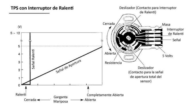
Algunos sensores TPS son de cuatro cables pues incorporan un interruptor adicional conocido como contacto de ralenti. Este interruptor se cierra cuando el papalote del cuerpo de aceleración está cerrado. En ese momento, la PCM mide 0 Volts en esa terminal. Cuando el papalote se abre, el interruptor se abre y la PCM mide voltaje B+ en dicha terminal.
