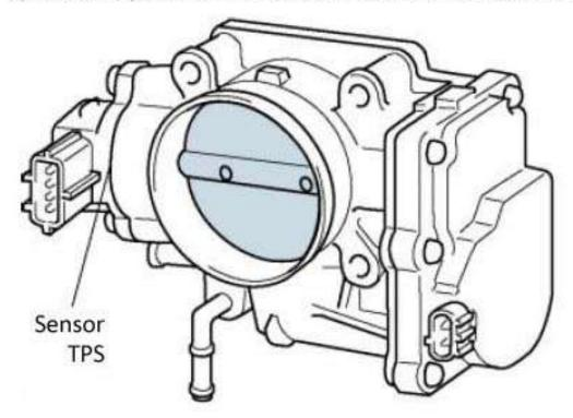
Observa que el sensor TPS es de 4 terminales, en lugar de 3 como ocurre en los sistemas convencionales. El diagrama de encendido electrónico te indica para que es cada terminal.
