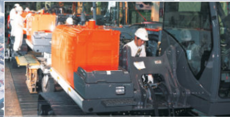
Đường lắp ráp máy xúc kích cỡ vừa
