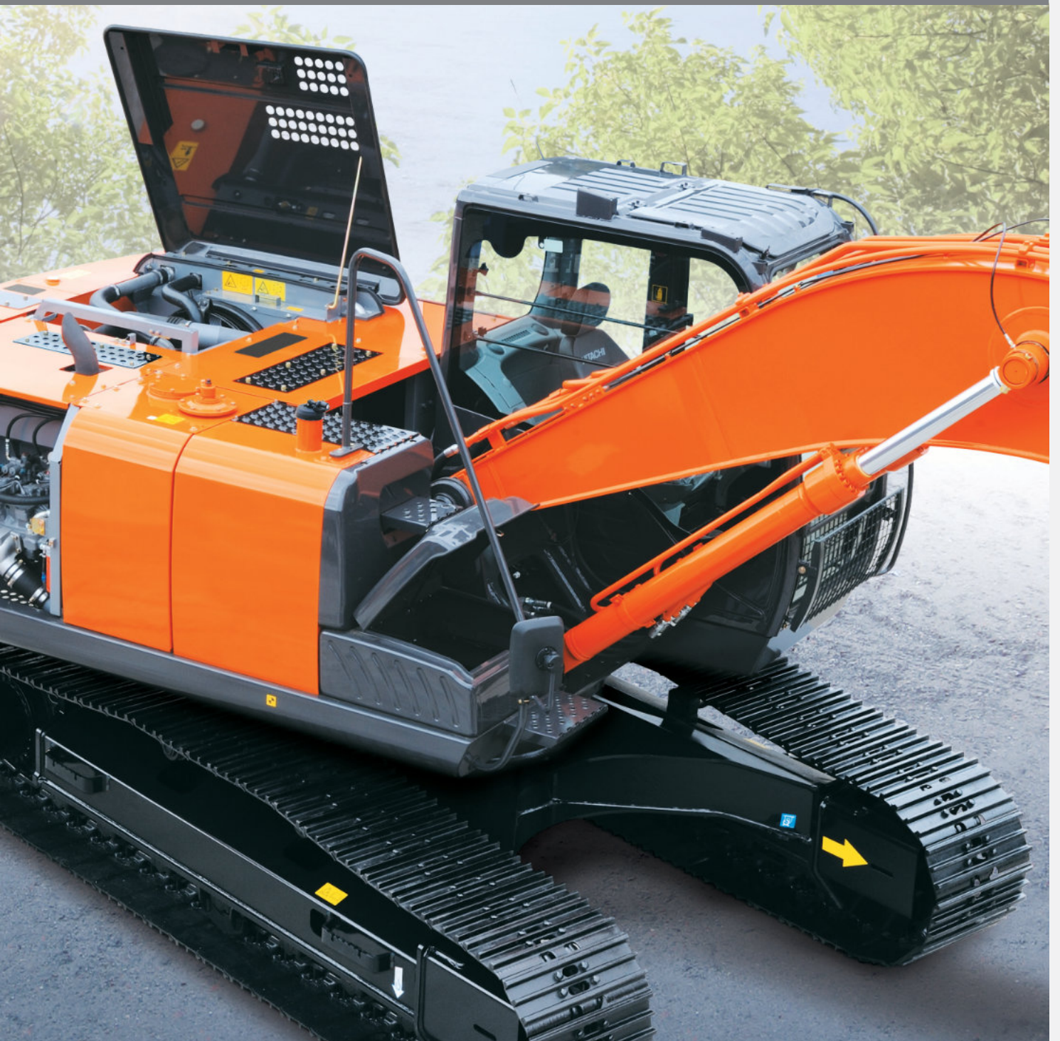
Hình ảnh cho thấy một máy xúc với chắn bảo vệ thấp phía trước buồng lái tùy chọn.
