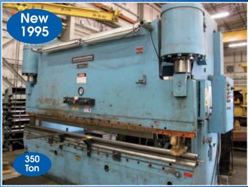
CLEARING/NIAGARA HYDRAULIC PRESS BRAKE
