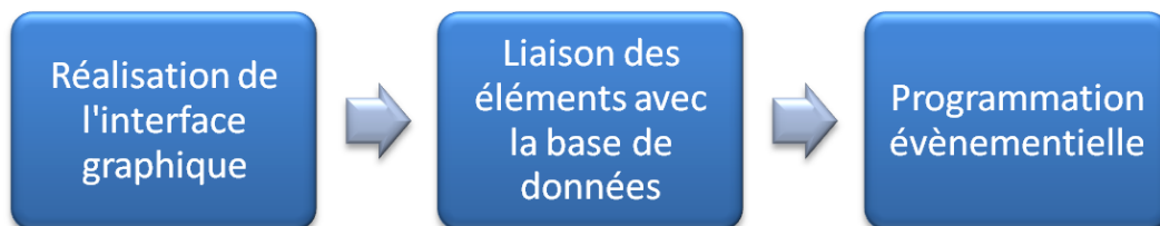
FIGURE 10 – Cheminement du développement d'une page ASP.NET
