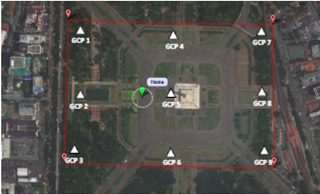
Gambar 10 Pola sebaran GCP untuk keperluan praktis
