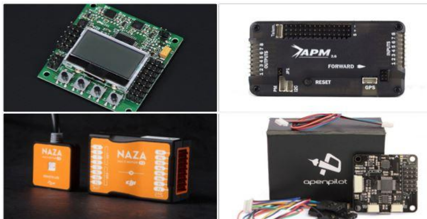
Gambar 3 Berbagai jenis Flight Control multi rotor.
