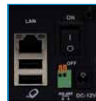
Lado Frontal de la DVR Conecte el Mouse y la Memoria USB
