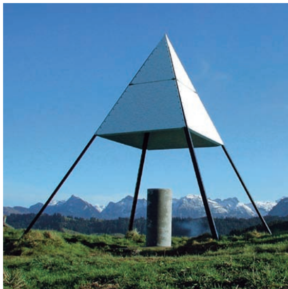
Photo ci-dessus: Station permanente de mesure par satellites, point fixe dans la nou- velle mensuration nationale
