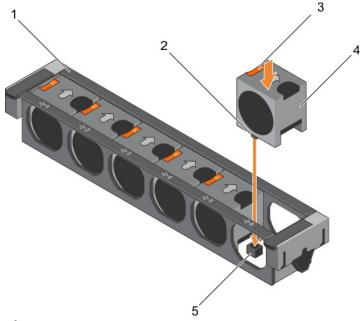
Figure 33. Installing a cooling fan
