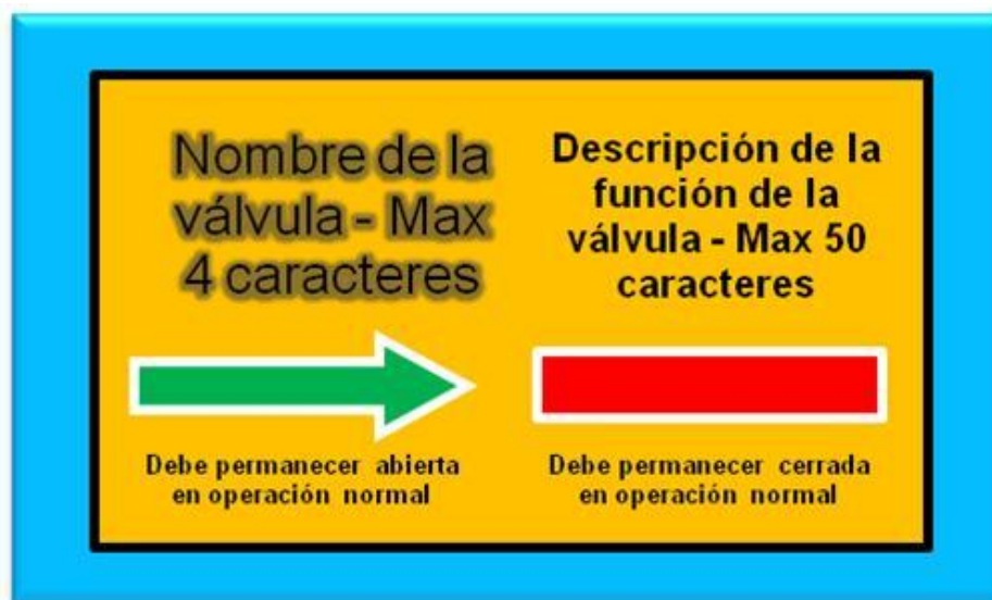
Figura 18. Forma propuesta de marcación visual de válvulas.
