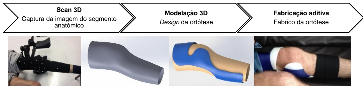
Figura 5.1 Aplicação do protocolo de produção proposto no desenvolvimento da ortótese relativa ao conceito 4.
