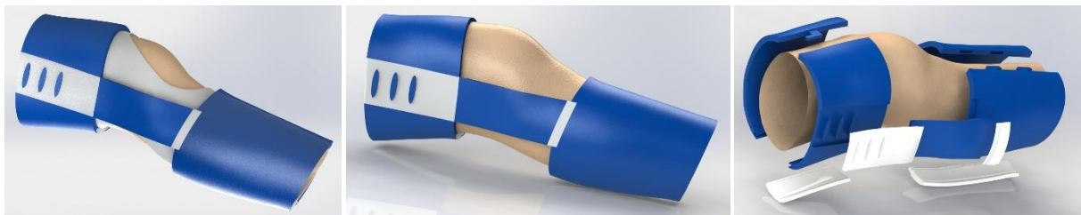
Figura 4.14 Modelo tridimensional do conceito 1, desenhado em Solidworks®.
