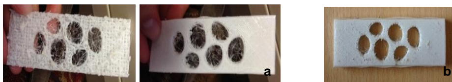
Figura 3.8 a) Peça obtida na primeira tentativa de impressão com Ninjaflex® . b) Peça obtida após otimização dos parâmetros de impressão.
