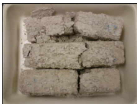
Figura 4.21 - Provetes da argamassa de consolidação ao fim do 5º dia de ciclos de gelo-degelo.
