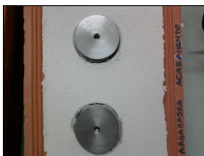
Figura 3.29 - Amostra de tijolo preparada para o teste de “Pull-Off”.
