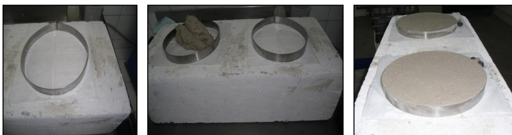
Figura 3.20 - Moldes e amostras para o ensaio da permeabilidade ao vapor.
