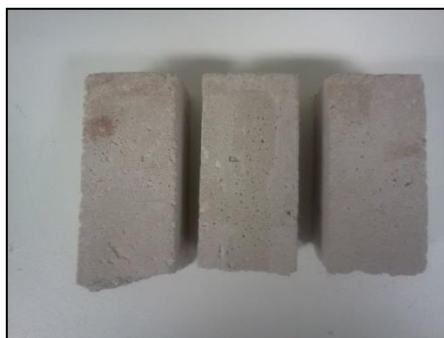
Figura 4.22 - Provetes da argamassa de reboco ao fim do 7º dia de ciclos gelo-degelo.
