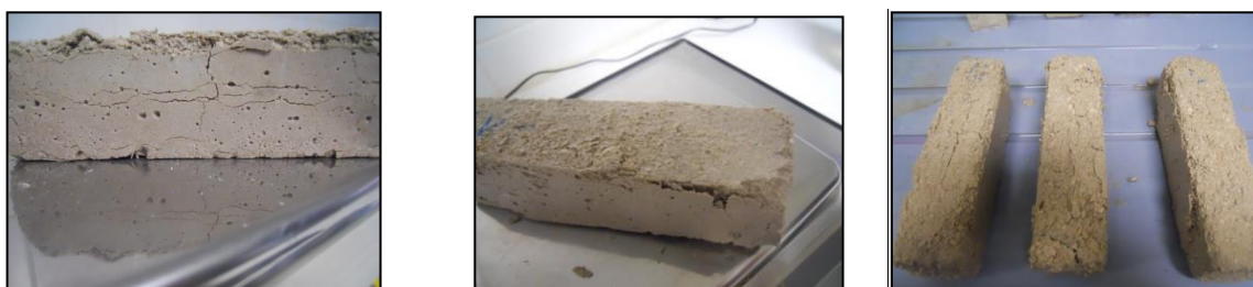
Figura 4.20 - Provetes da argamassa de consolidação ao fim do 3º dia de ciclos de gelo-degelo.
