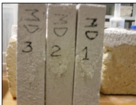
Figura 4.13 - Cristalização de sais em provetes da argamassa de reboco.
