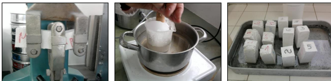
Figura 3.23 - Corte em duas partes dos provetes (à esquerda); Dissolução da parafina, em banho-maria (ao centro); Imersão da superfície partida do provete em água (à direita).
