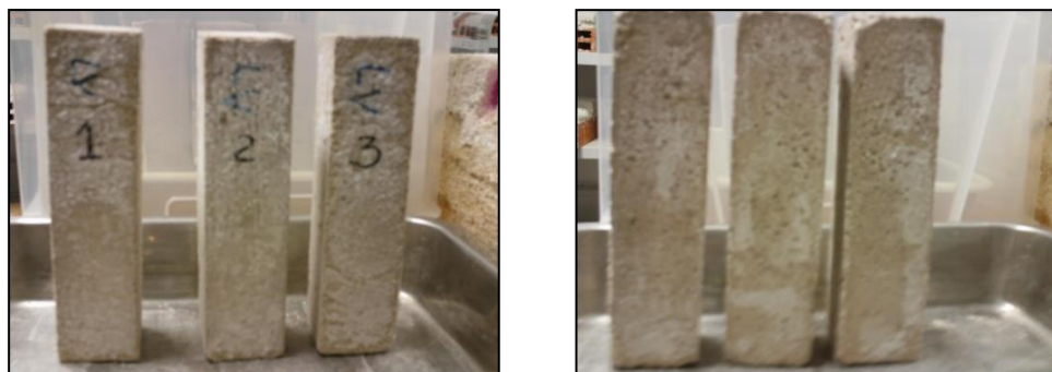
Figura 4.12 - Cristalização de sais em provetes da argamassa de consolidação.
