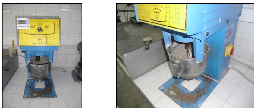
Figura 3.1 - Misturadora mecânica (à esquerda); Amassadura a decorrer (à direita).
