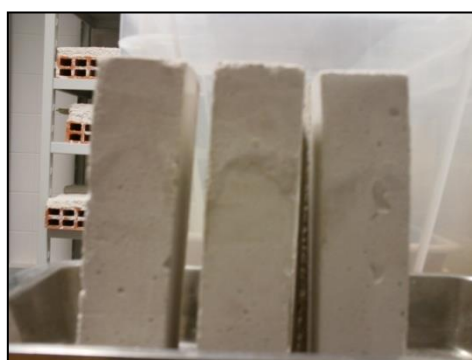
Figura 4.14 - Cristalização de sais em provetes da argamassa de acabamento.
