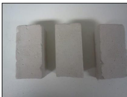
Figura 4.23 - Provetes da argamassa de acabamento ao fim do 7º dia de ciclos gelo-degelo.
