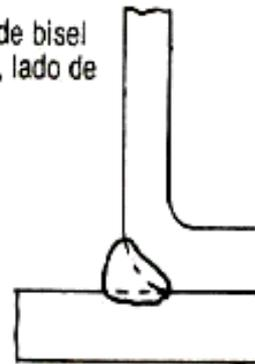
Símbolo de soldadura de bisel y ranura con curvatura, el otro lado
