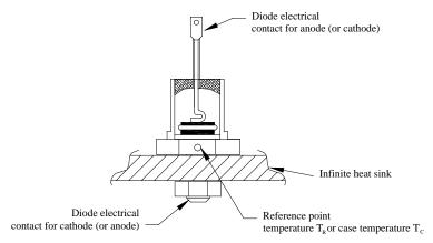
FIGURE 4081-3. Case mounting arrangement. (stud packages).
