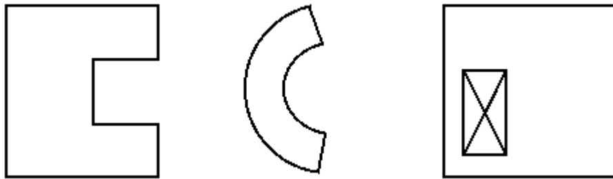
FIGURA 1.6 Formas geométricas en planta que son indeseables por tender a producir vibración torsional.
