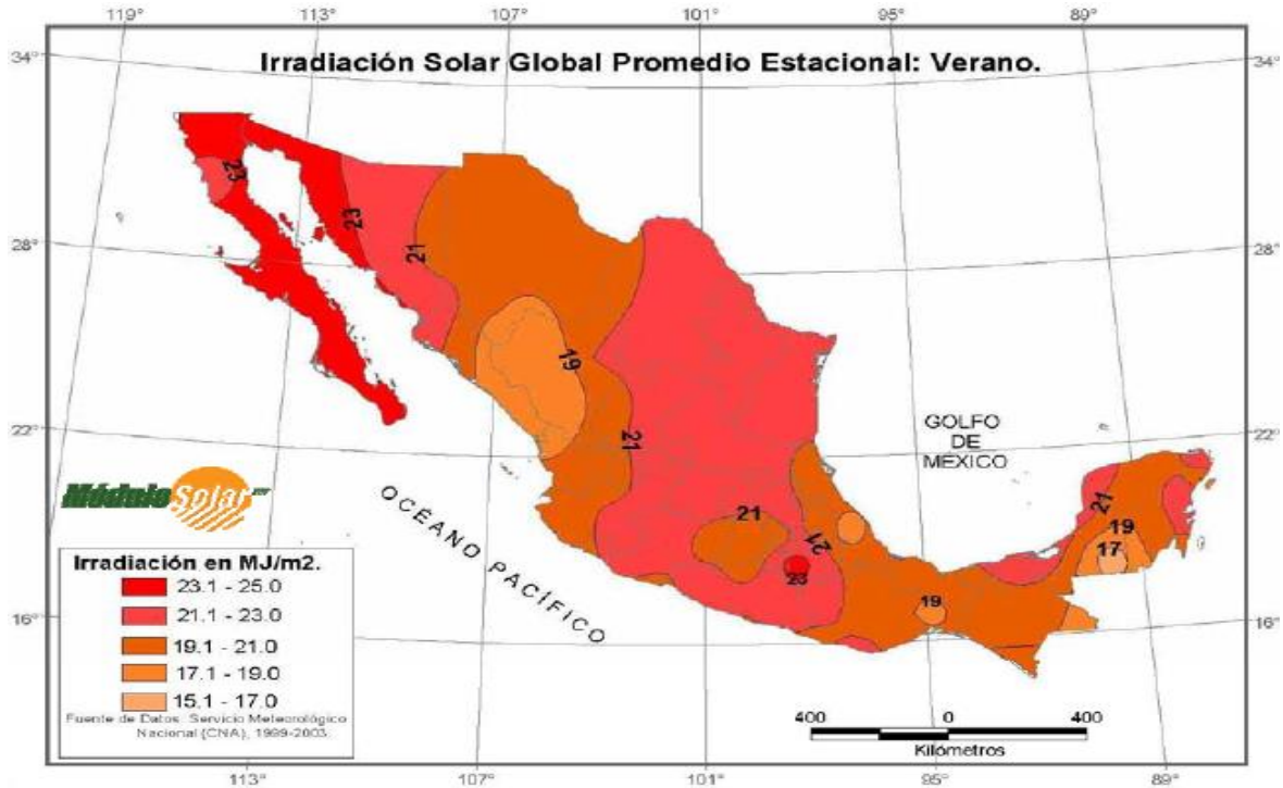
Imagen 10: Zonas de irradiación en México. Fuente Modulo Solar.
