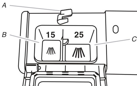
A. Loquet du couvercle C. Section de lavage principal B. Section pré-lavage
