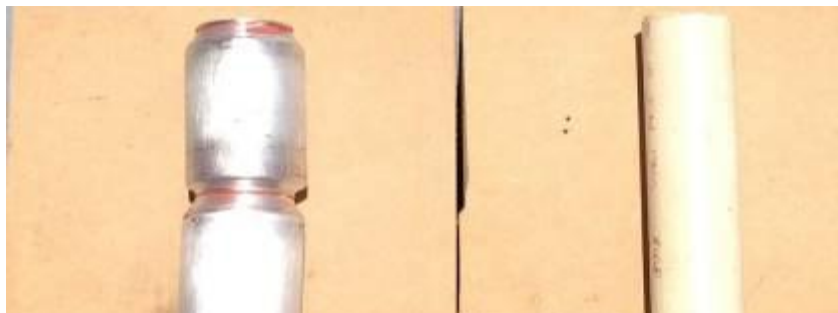
Figura 3. Latas de aluminio unidas con resina epóxica y tubo de CPVC de 24 cm de longitud .
