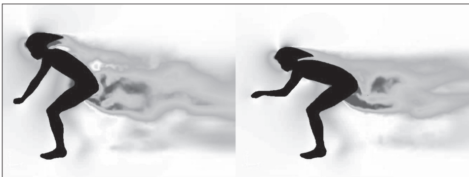
Figuur 2.9. De vergelijking van het stromingsveld (ogenblikkelijke lichtsnelheid) in het zog van twee typische fietshoudingen. De aanstroomsnelheid van de lucht (langs links) komt overeen met de gele kleur. In de groene, lichtblauwe en donkerblauwe zones vertraagt de lucht.
