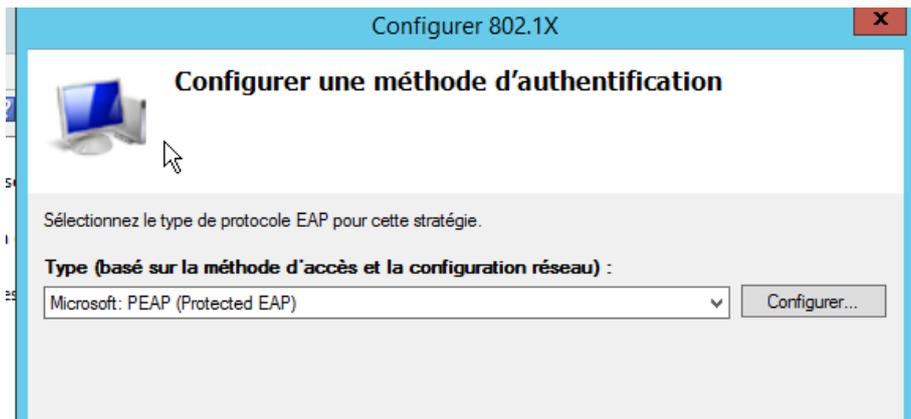
Figure 15 : Configuration du type de protocole EAP pour la stratégie
