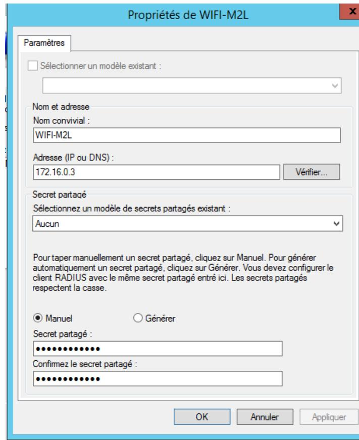
Figure 14 : Ajout d'un client Radius
