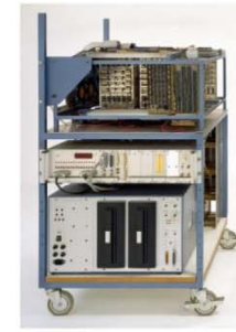
Bitscheibenprozessor für erste Echtzeit- Codierung 1980
