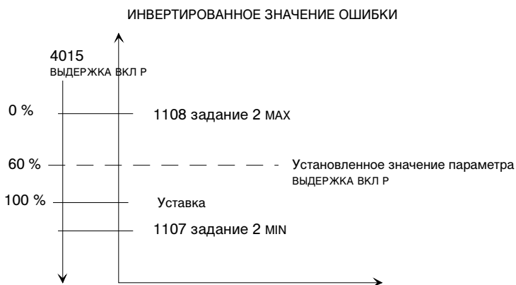
Рис.25 Пример смещения установленного значения уровня деактивации функции отключения; параметр 4015 WAKE-UP LEVEL равен 60 %, ПИД-управление с инверсией.
