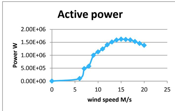
FIGURE 18 POWER CURVE FOR FIXED-SPEED WIND TURBINE
