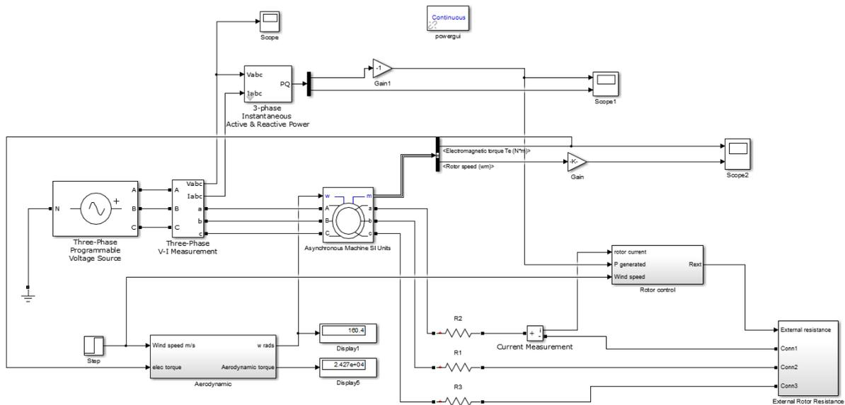
FIGURE 24 VARIABLE SLIP WIND TURBINE COMPLETE MODEL
