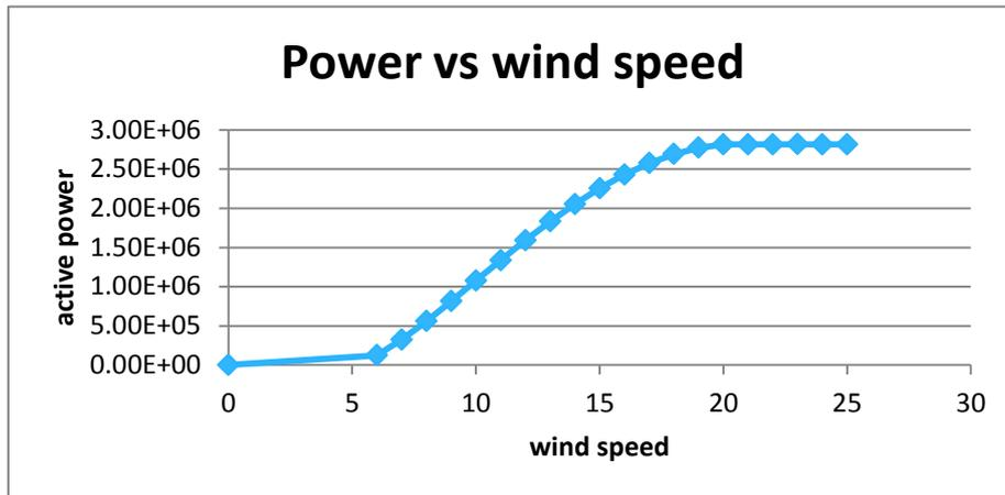
FIGURE 25 VARIABLE SLIP WIND TURBINE POWER CURVE
