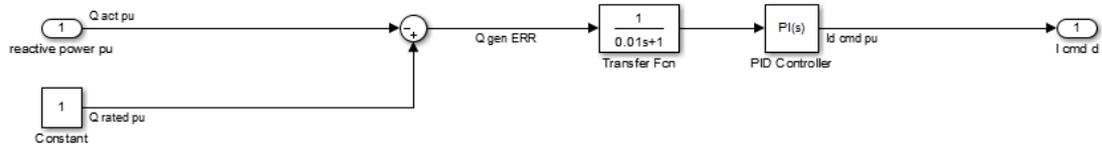
FIGURE 32 REACTIVE POWER CONTROL BLOCK
