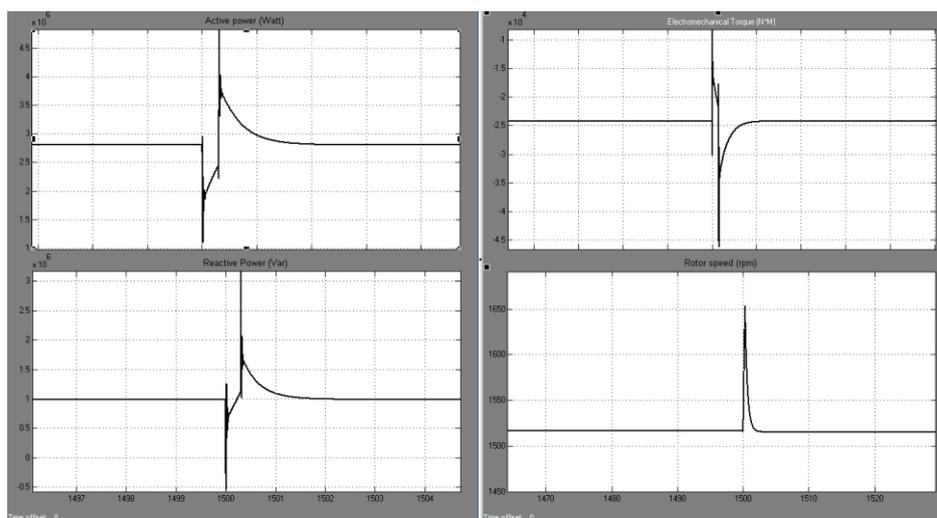
FIGURE 28 TURBINE CHARACTERISTICS UNDER VOLTAGE SAG
