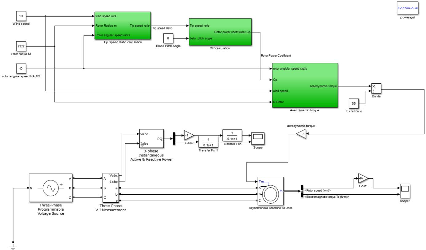
FIGURE 17 SCHEMATIC DIAGRAM FOR FIXED-SPEED WIND TURBINE
