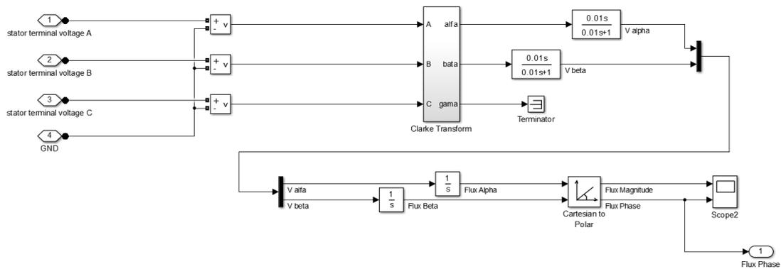
FIGURE 14 FLUX CALCULATION BLOCKS IN SIMULINK
