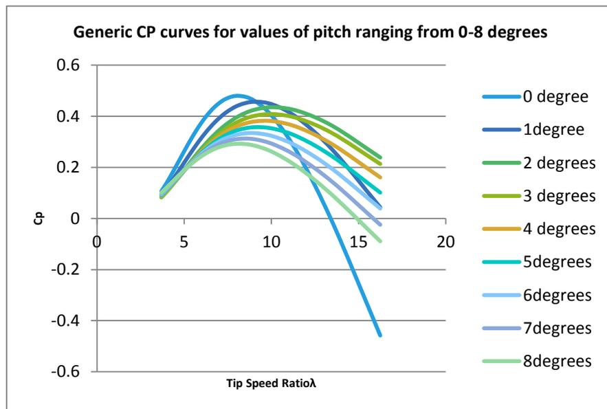
FIGURE 3 ROTOR POWER COEFFICIENT VERSUS TIP SPEED RATIO
