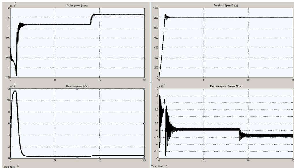
FIGURE 19 FIXED SPEED WIND TURBINE CHARACTERISTICS UNDER WIND DISTURBANCE
