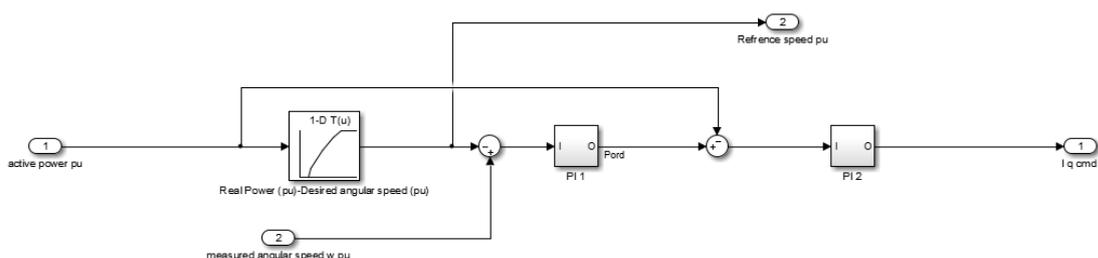
FIGURE 31 ACTIVE POWER CONTROL BLOCK
