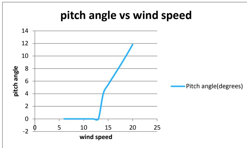
FIGURE 36 PITCH ANGLE VERSUS WIND SPEED
