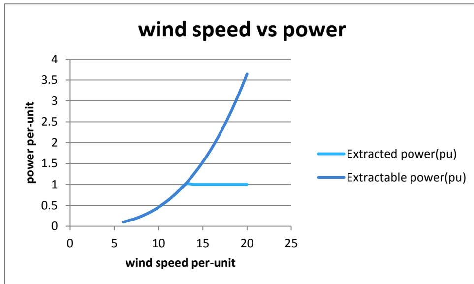
FIGURE 35 EXTRACTABLE POWER VERSUS EXTRACTED POWER
