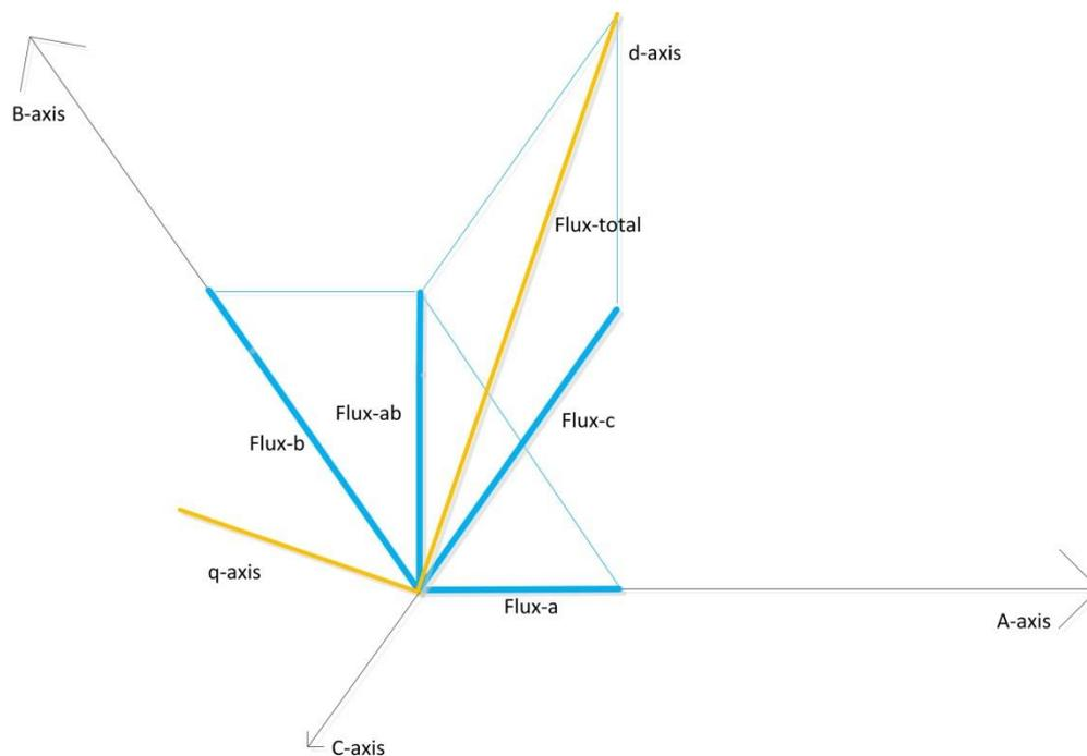
FIGURE 13 FLUX TRANSFORMATION FROM ABC TO DQ0 REFERENCE FRAME
