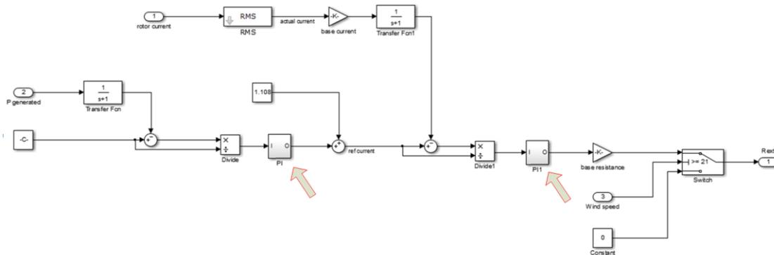
FIGURE 23 VARIABLE SLIP WIND TURBINE CONTROL SYSTEM
