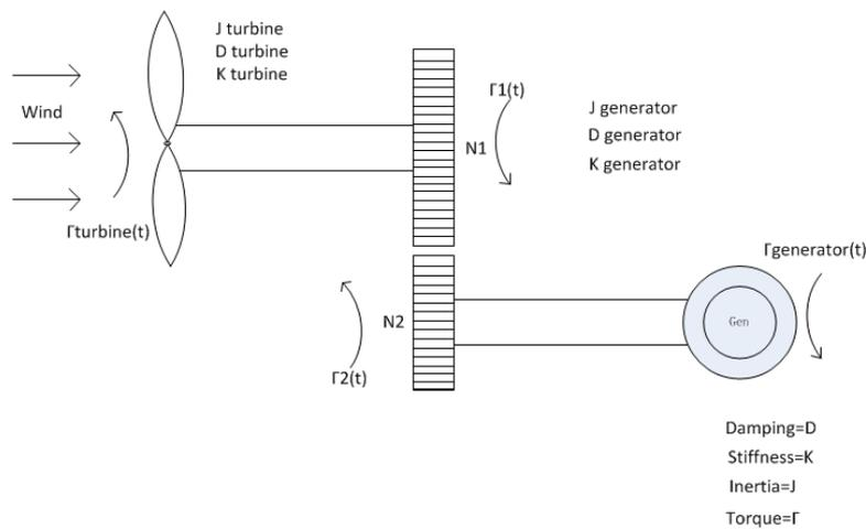
FIGURE 4 REPRESENTATION OF A TWO-MASS MODEL DRIVE TRAIN (MOHIT S. , 2011, P. 20)
