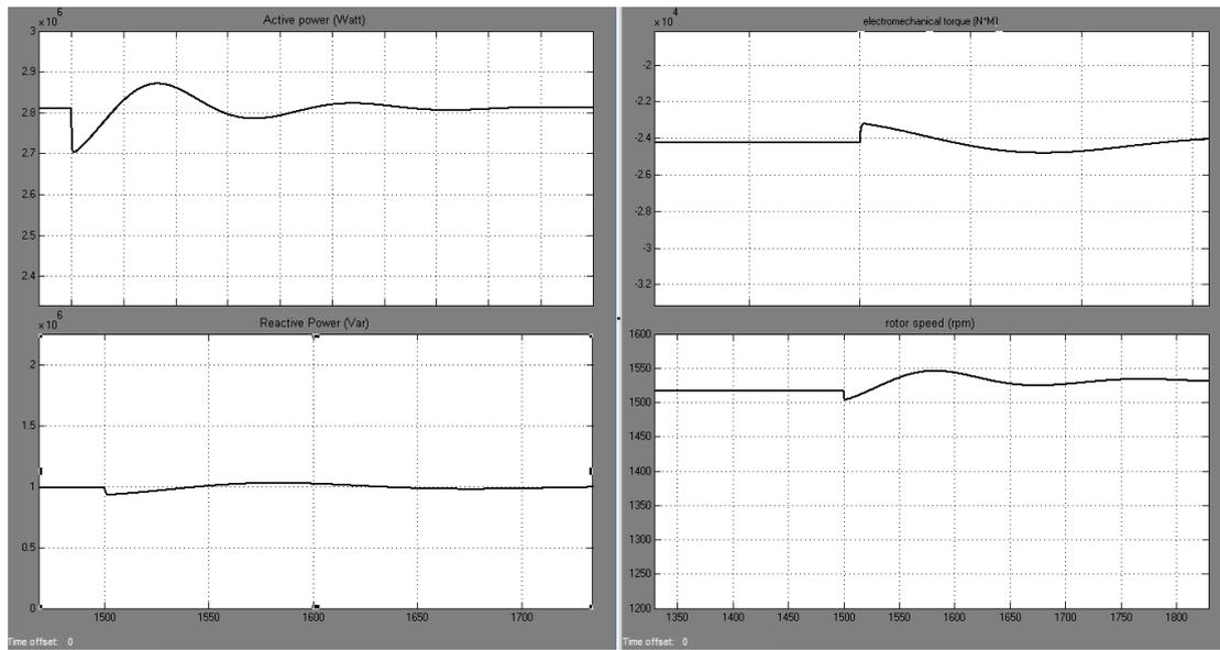
FIGURE 27 VARIABLE SLIP WIND TURBINE CHARACTERISTICS UNDER WIND DISTURBIANCE
