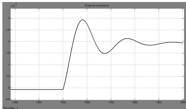
FIGURE 26 VARIABLE SLIP EXTERNAL RESISTANCE UNDER WIND DISTURBANCE
