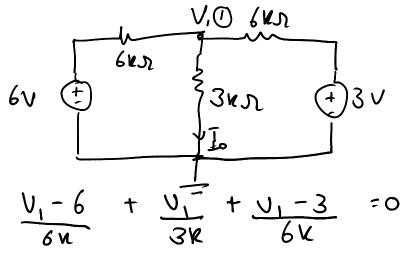
$$V_{1} - 6 + 2V_{1} + V_{1} - 3 =$$
