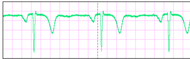
Figura 25 – Derivação avR simulada via software com escala de amplitude de 500mV/div e de tempo de 200ms/div.
