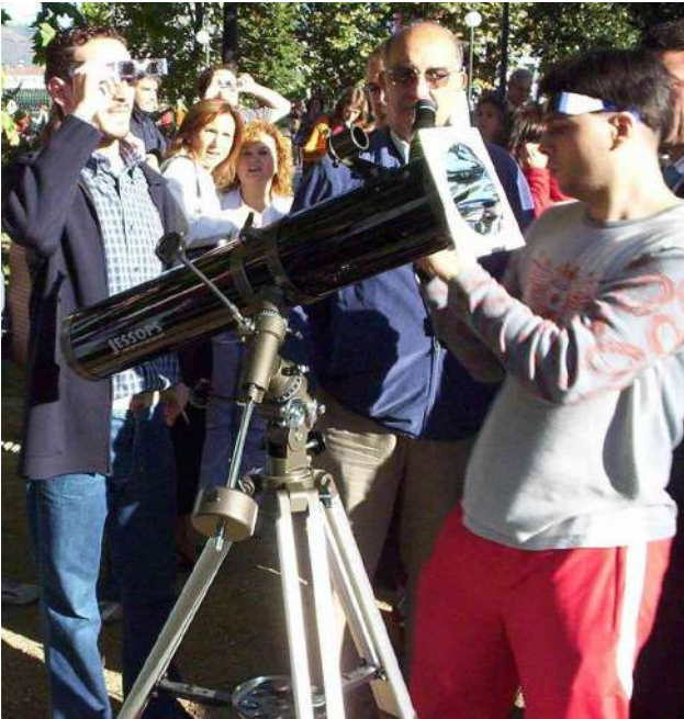
Imagen 25: telescopio reflector con una lámina de Baader montada en cartón.
