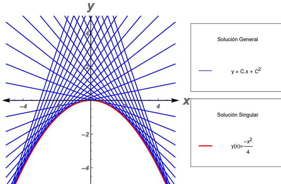
**Figura 6.3:** gráfica de la solución singular  $y(x) = -\frac{x^2}{4}$  y solución general  $y(x) = Cx + C^2$ .
