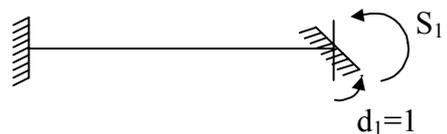
Figura 3-7: Esforço na barra causado por um deslocamento unitário
