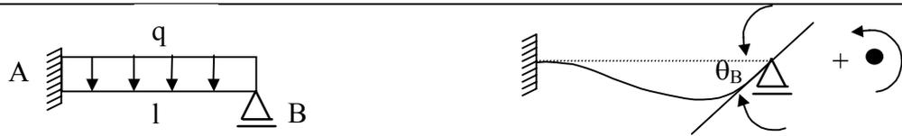
(a) Viga engastada-apoiada (b) Deformada da viga engastada-apoiada
