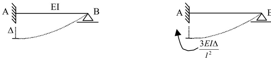
Figura 4-73: Viga engastada-apoiada com recalque no apoio A
