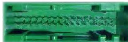
Die Installation wird hinter der Navigationseinheit vorgenommen. Dazu muss diese ausgebaut werden. Der Anschluss wird am 32 Pin Stecker durchgeführt.
