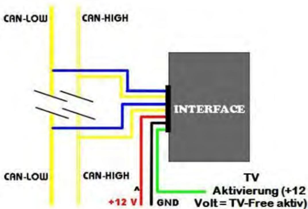
Interface zwischen CAN-High und CAN-Low des Fahrzeugs einbauen.
