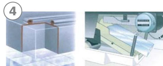
4 Das Eis fällt vom Verdampfer in den Eisbehälter. Die Wasserplatte wird mit frischem Wasser gespült, um alle noch vorhandenen Partikel zu entfernen und beginnt, sich erneut zu schließen. Frisches Wasser tritt ein, bis der Behälter gefüllt ist und ein neuer Gefrierzyklus beginnen kann.
