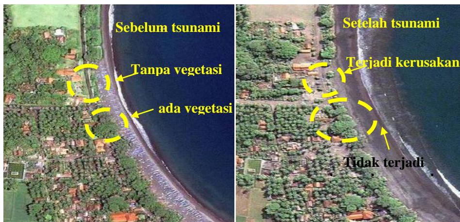
Gambar 27. Gambar Ikonos yang memperlihatkan peran hutan pantai dalam mereduksi tsunami di Pangandaran Jawa Barat, tampak sebelum dan setelah tsunami tahun 2006. (sumber: CRPS, www.crips.nus.edu.sg )
