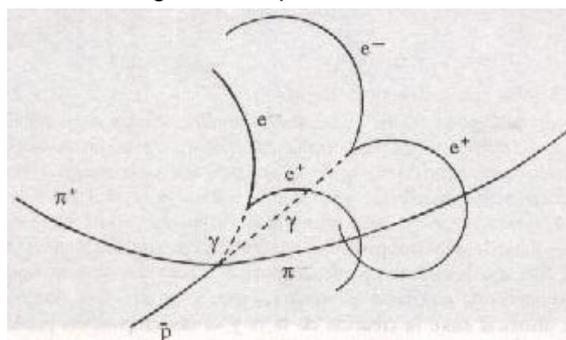
Una secuencia de sucesos en la que ocurren dos creaciones: un antiprotón ( $\bar{p}$ ) llegando desde abajo colisiona con un protón de la cámara (le burbujas creando un  $\pi^+$  (que sale proyectado hacia la izquierda), un  $\pi^-$  (que surge hacia la derecha) y dos fotones ( $\gamma$ ), cada uno de los cuales crea un par electrón-positrón. Los positrones ( $e^+$ ) se curvan hacia la derecha, los electrones ( $e^-$ ) hacia la izquierda.
