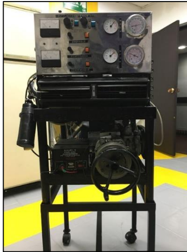
Figura 14. Módulo didáctico de acondicionamiento de aire móvil
