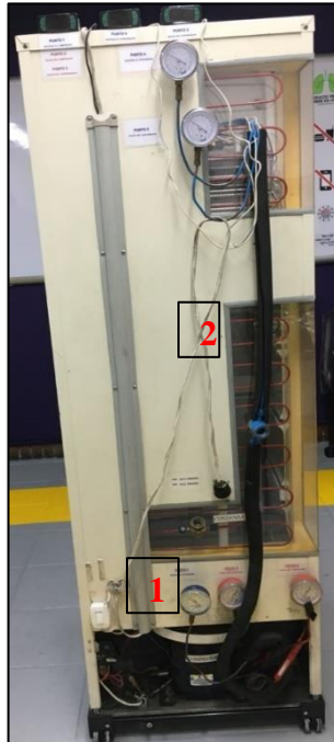
Figura 10. Módulo didáctico de nevera No-frost. Exterior
