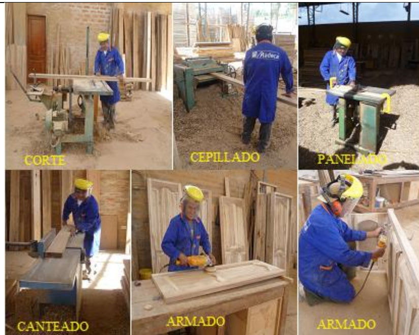
Gráfico 3.3 Proceso productivo de puertas y muebles, instalaciones fábrica MADECA
