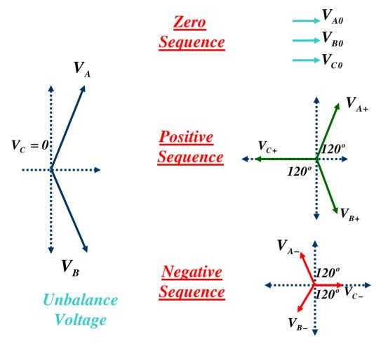
$$V_{A} = V_{A}^{0} + V_{A}^{+} + V_{A}^{-}$$
