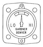
FIGURE 5-6 - OIL LEVEL GAUGE
