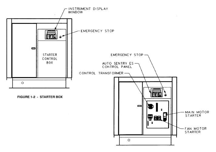
FIGURE 1-3 - PACKAGE - CONTROLLER & STARTERS
