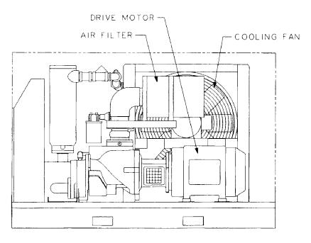
FIGURE 1-4 - PACKAGE - DRIVE MOTOR & AIR FILTER
