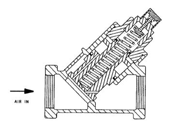
FIGURE 4a-4 - MINIMUM DISCHARGE PRESSURE VALVE
