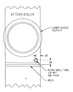
FIGURE 5-5 - COOLER DRAIN DETAIL
