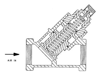
FIGURE 4b-6 - MINIMUM DISCHARGE PRESSURE VALVE
