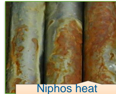
Ni 10 µm + Cr 10 µm, 72 h
