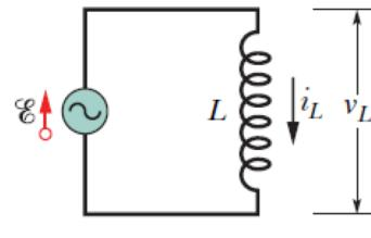
$$v_L = V_L \sin \omega_d t, \qquad v_L = L \frac{di_L}{dt}.$$
