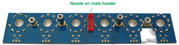
Metal spacer fittingDi M3 x 6Di M3 x 12Di M3 x 12Di M3 x 6
