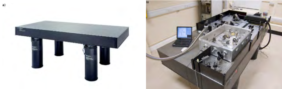
Figura 3.1: Imágenes de una mesa óptica y el arreglo físico de un espectrómetro. a) Mesa óptica donde se monta el arreglo espectroscópico, Newport Research. b) Arreglo del sistema espectroscópico en el dominio del tiempo de la universidad de Oxford, Oxford Reino Unido.
