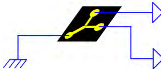
Figura 3.6: Conexiones en la antena fotoconducativa que realiza la función de detector, la cual une a los contactos con el instrumento de medición, el cual en nuestro caso es un amplificador “Lock-in”.
